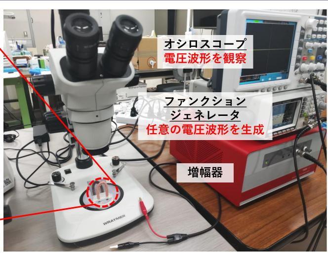
コイルへの電圧波形によって、磁性ピラーがたわむ量や周波数を制御できた
