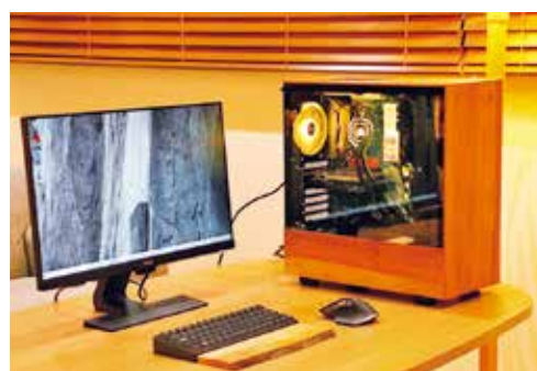
図1 試作したPCケースおよびパームレスト
